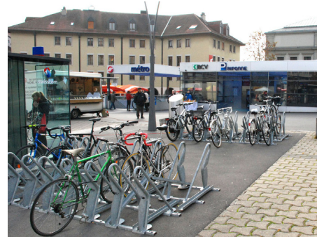
[fig. 2] Râtelier à vélos avec support pour cadre, place de la Riponne | © Ville de Lausanne
