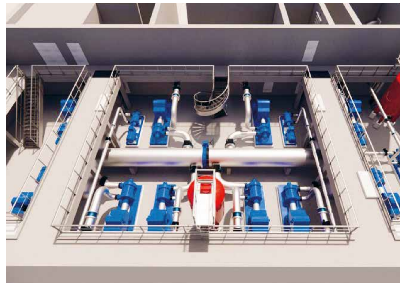
Capture d'écran BIM de la station de pompage de l'eau traitée vers les réservoirs (future usine de Saint-Sulpice).
