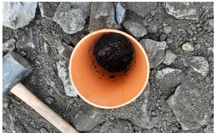
*Conclusion* : Perméabilité assez rapide 36-360 mm/h, la mise en place au balai n'est pas concluante, la souffeuse semble donner de bons résultats. Sur 30cm le TP70 a du mal à descendre jusqu'en bas de la couche.
