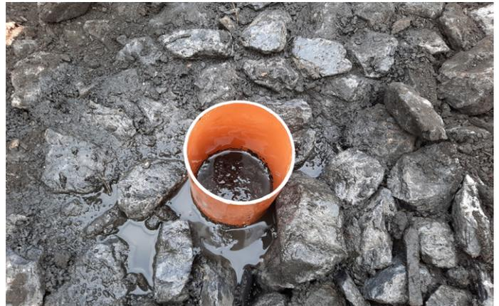
*Conclusion* : perméabilité faible < 10 mm/h, le TP70 n'est pas entièrement descendu dans les pierres et reste en surface
