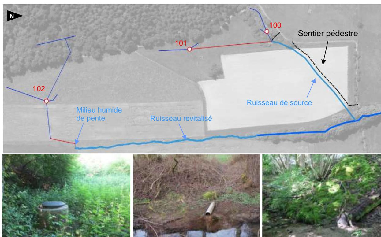
Figure 24: Revitalisation des sources de la Plaine de Mauvernay, illustration des travaux.
