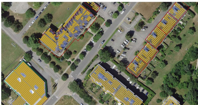
Figure 7 : Exemple d'adaptation à la géométrie par Urbio (panel fitter)
