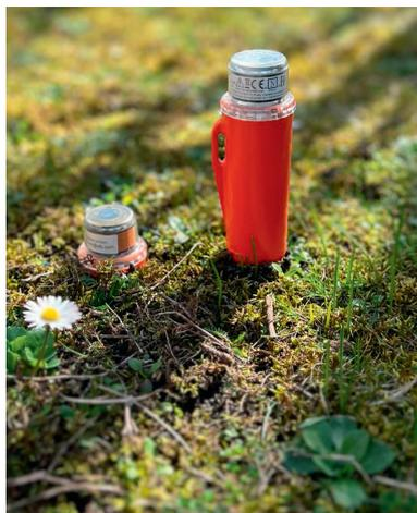
Pour les propriétaires de parcelles, les géophones seront déposés et retirés à pied et impliqueront un trou de 4 cm de diamètre sur 10 cm de profondeur. Aucune trace ne sera ainsi laissée par la pose et le retrait de ces capteurs géolocalisés qui mesurent environ 15 centimètres de hauteur. Les géophones seront posés deux à trois semaines avant les mesures et il est important de ne pas les toucher.
