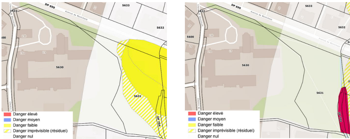
Figure 2-3 : Carte des dangers naturels A gauche : risque de glissement de terrain spontané. A droite : risque d'inondation (Geoportail VD, 2020)
