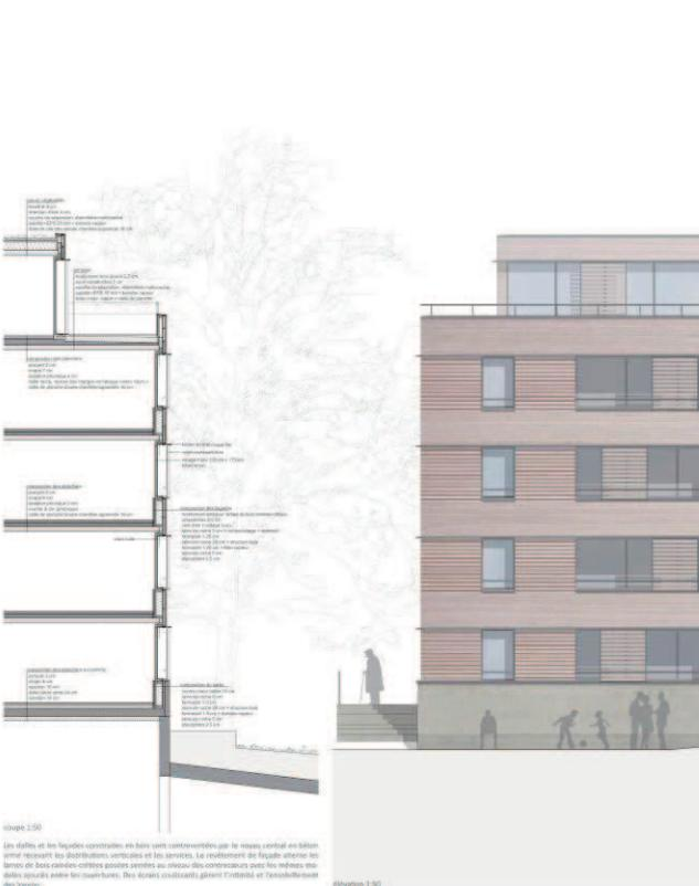
**coupe 1:50** Les dalles et les façades construites en bois sont contreventées par le noyau central en béton pour assurer la stabilité verticale et les services. Le renforcement de façade assure les liaisons de bois entre les poteaux et les murs de contreventement pour les relier aux dalles et assurer la stabilité globale. Des détails constructifs garantissent l'étanchéité et l'isolation thermique des façades.
