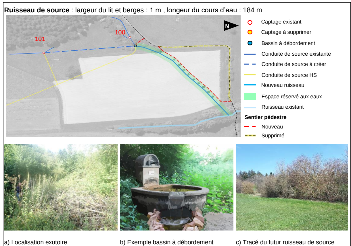
Illustration 1 : Description de la mesure 1 de revitalisation, tracé du futur ruisseau de source.
