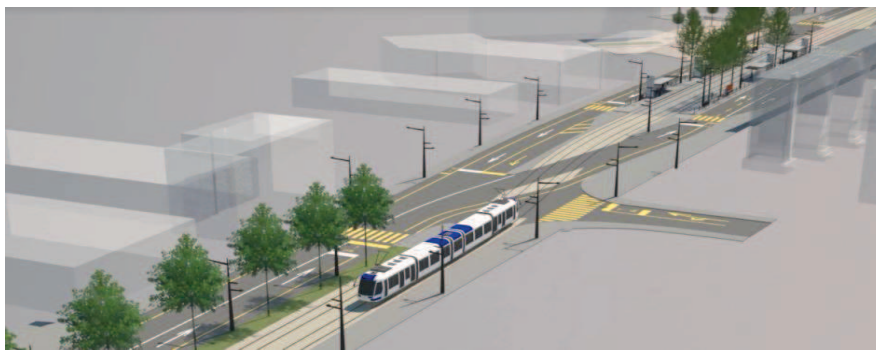
Bascule entre le positionnement latéral et central du tramway dans le secteur du Galicien
