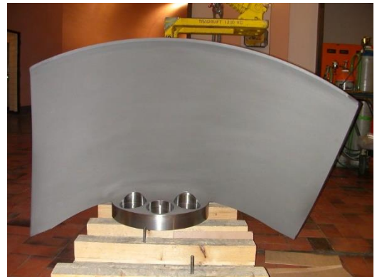
Pale réparée avec la protection anti-usure
