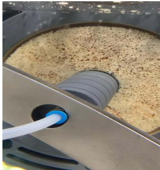
Figure 62 : Test d'intégrité de la membrane usagée à la fin de la période de pilotage.
