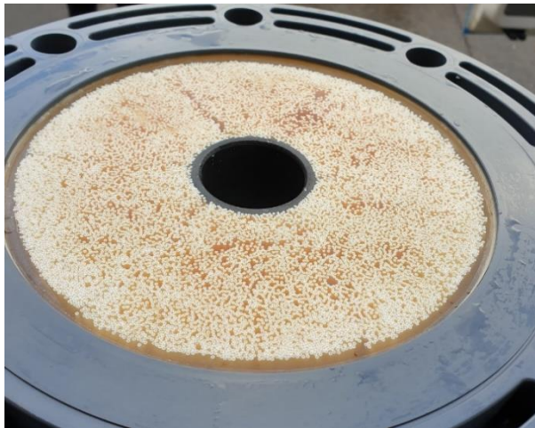
Figure 17 : Un module NF à fibres creuses avec mode de fonctionnement 'Inside-Out'.
